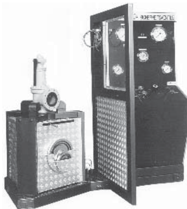
شکل (۲) یک شیر اطمینان در حال تست بر روی میز تست شیرآلات
